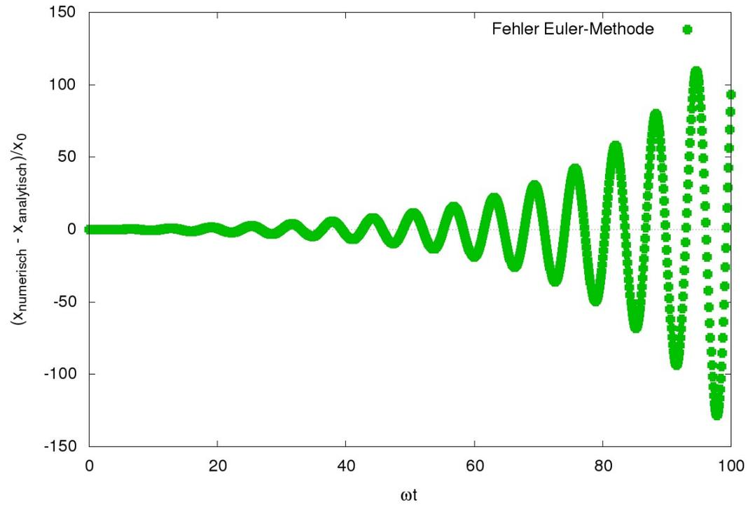
HO:  $V(x) = m\omega^2 x^2/2$ , ABs  $x(t=0) = x_0$ ,  $v(t=0) = 0$ , Schrittweite  $\omega\tau = 0.1$
