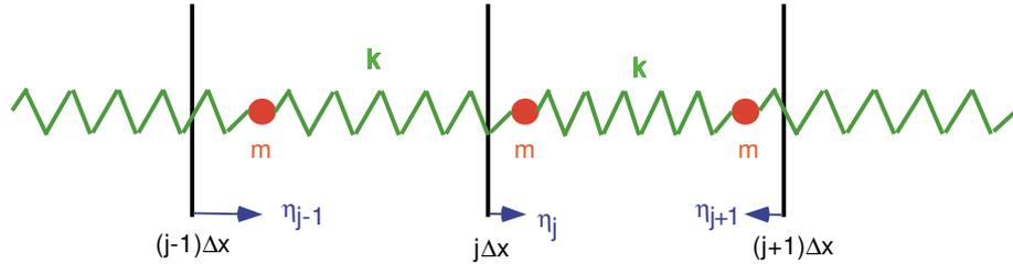
Zerlegung eines schwingenden Stabes in diskrete, durch Federn gekoppelte Punktmassen. Die Größen  $\eta_j$  geben die Auslenkung aus der jeweiligen Ruhelage  $x_j = j \Delta x$  wieder.
