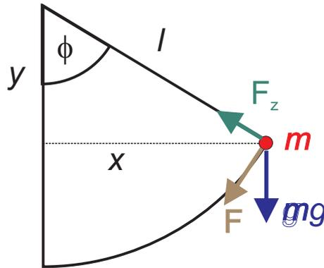
Das Bild illustriert auch die Kräfte: zur Gewichtskraft kommt die Zwangskraft (grün) hinzu, die der Faden ausübt, so dass die resultierende Kraft (braun) in tangentialer Richtung steht.
