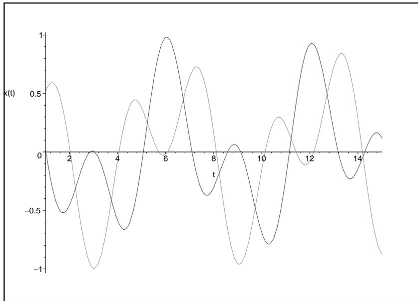
Illustration der Schwingungen der beiden Massenpunkte für den Fall  $\omega_- = 1$  und  $\omega_+ = 2.1$ .
