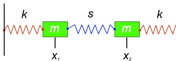
Es seien zwei Oszillatoren miteinander und jeweils mit der Wand über Federn gekoppelt. Der Einfachheit halber haben die beiden äußeren Federn dieselbe Federkonstante  $k$ , und die Massen seien beide gleich  $m$ . Die innere Feder habe die Federkonstante  $s$ .
