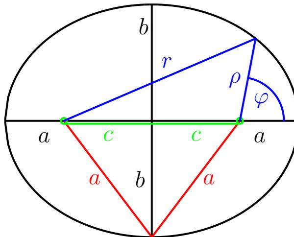
Die Definition der Ellipse besagt, dass die Summe der Abstände eines beliebigen Punktes auf der Ellipse zu den beiden Brennpunkten konstant sein muss,  $r + \rho = \text{const.}$  Wenn man den Punkt auf der  $x$ -Achse bei  $\pm a$  wählt, findet man die Konstante:
