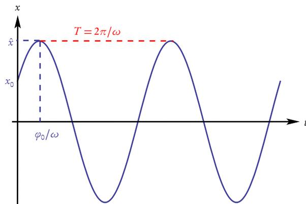
Abbildung 3: Lösung zum harmonischen Oszillator mit den Kenngrößen  $\hat{x}$  (Amplitude),  $\varphi_0$  (Anfangsphase) und  $T$  (Periodendauer).
