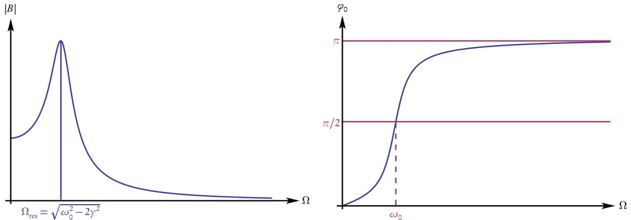
Abbildung 6: Amplitudenfaktor (links)  $|B|$  und Phasenverschiebung  $\varphi_0$  für den eingeschwungenen Zustand (80).
