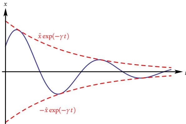
Abbildung 4: Lösung zum gedämpften harmonischen Oszillator. Für  $\omega_0 > \gamma$  schwingt der Massenpunkt wieder sinusförmig auf und ab, aber die Amplitude ist exponentiell gedämpft. Die Dämpfungsrate ist  $\gamma$ .
