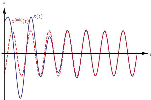
Abbildung 5: Lösung zum getriebenen gedämpften harmonischen Oszillator im Schwingfall  $\omega_0 > \gamma$ . Für  $t \gg 1/\gamma$  werden die Eigenschwingungen, also der Anteil der Lösung der homogenen Gleichung in (70) merklich gedämpft, und die Bewegung geht in den durch die spezielle Lösung der inhomogenen Schwingung eingeschwungenen Zustand über.
