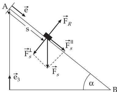
Ein Teilchen P der Masse  $m$  rutscht unter dem Einfluß der Schwerkraft reibungslos entlang einer schiefen Ebene AB, die unter einem Winkel  $\alpha$  zur Horizontalen geneigt ist (vgl. Abb.). Das ruhende Teilchen wird zum Zeitpunkt  $t = 0$  am Punkt A losgelassen. Finden Sie die Geschwindigkeit, die Beschleunigung und den zurückgelegten Weg als Funktion der Zeit.
