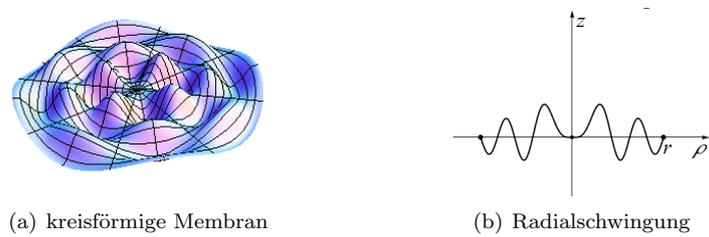
Abbildung 3.5: (a) Zeigt eine der vierten Moden der kreisförmigen Membran. (b) Zeigt die Schwingungsausbreitung in Radialrichtung.
