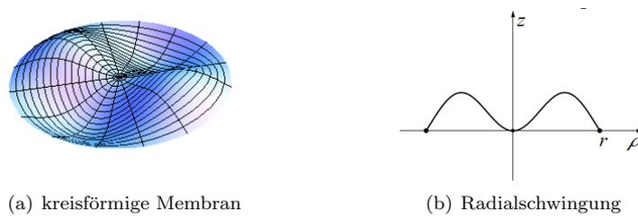
Abbildung 3.4: (a) Zeigt eine der zweiten Moden der kreisförmigen Membran. (b) Zeigt die Schwingungsausbreitung in Radialrichtung.
