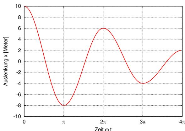
Man sieht, daß die Amplitude der Schwingung linear mit der Zeit kleiner wird, was auf die Dämpfung durch die Reibung zurückzuführen ist. Die Masse bleibt stehen, wenn für  $\dot{x} = 0$  die Federkraft kleiner wird als die Haftreibungskraft, d.h. also für  $k|x(\omega t = l\pi)| < \mu_b mg$ , d.h. zu Zeiten  $\omega t \geq l\pi$  mit
