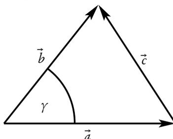
Aus der Zeichnung liest man ab, dass  $\vec{a} + \vec{c} = \vec{b}$  und also  $\vec{c} = \vec{b} - \vec{a}$  ist. Daraus folgt
