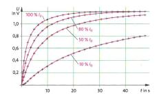
(c) (5 Punkte) Wir betrachten nun den zeitlichen Verlauf der Aufladung des Kondensators, d.h. wir suchen die im Plot gezeigte Funktion U(t). Beachten Sie dazu, dass die momentan im Kondensator gespeicherte Energie  $E(t) = C U^2(t)/2$  ist, wobei C die Kapazität des Kondensators ist. Begründen Sie nun, warum aufgrund des Energieerhaltungssatzes die Energieänderung pro Zeiteinheit durch
