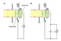
(a) (2 Punkte) Wir betrachten zuerst den Versuchsaufbau (a): Licht von einer Quecksilberdampflampe fällt auf eine Photozelle mit aus Cäsium bestehender Anode und Kathode. Es werde bei diesem Aufbau der Strom  $I_0$  gemessen. Erläutern Sie, wie im Photonenbild der gemessene Photostrom  $I_0$  mit der Intensität des einfallenden Lichtes zusammenhängt.
